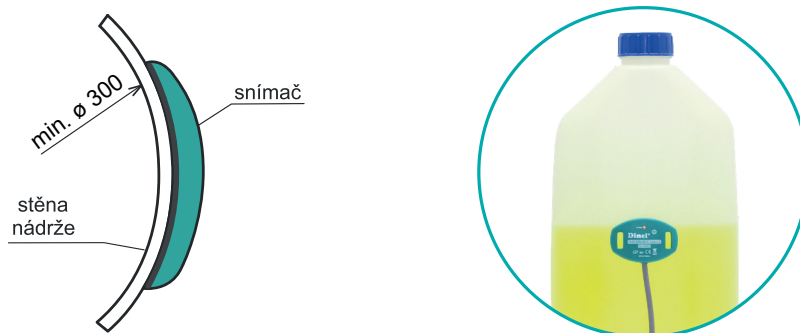
Upevnění FLD-32 pomocí samolepicí vrstvy
