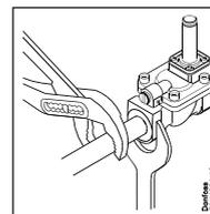
5. Toujours utiliser un contrepoids lors du serrage des raccords. Utiliser par exemple une clé tricoise sur le corps de vanne et le raccord de tuyau.
