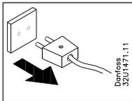
1. Vor dem Entfernen der Spule muss die Spannung getrennt werden, andernfalls brennt die Spule durch.
