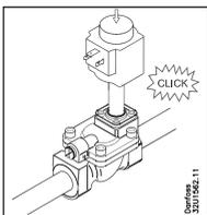
4. Befestigen Sie die Spule am Ventil. Wenn die Spule richtig positioniert ist, muss sie mit einem Klickgeräusch einrasten.
