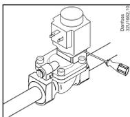
2. Die Spule wird mit einem Schraubendreher vom Anker gehoben.
