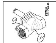
3. Der auf Ventilgehäuse und Deckel eingegossene Pfeil muss in Strömungsrichtung weisen.
