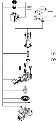
Induit, joints toriques, ressort, membrane
