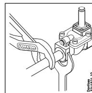
5. Verwenden Sie beim Festziehen der Rohrverbindungen eine Gegenkraft, d. h. setzen Sie einen Schraubenschlüssel sowohl am Ventilgehäuse als auch am Rohranschlussstutzen an.
