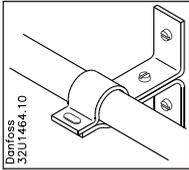
6. Die Rohre auf beiden Seiten des Ventils müssen gut befestigt sein.
