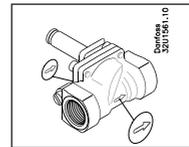
3. La flèche présente sur le corps et le couvercle doit être orientée dans le sens du débit.
