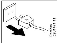
1. Avant de retirer la bobine, la mettre hors tension pour éviter qu'elle ne grille.
