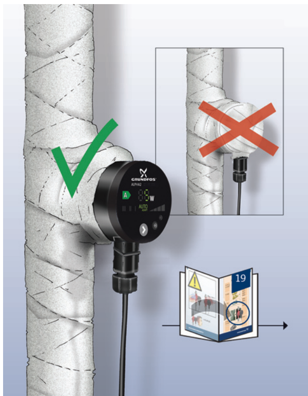
Obr. 5 Izolace tělesa čerpadla
