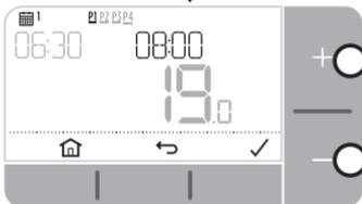
7. Pomocí tlačítek + a – nastavte požadovanou teplotu a po té stiskněte tlačítko ✓
