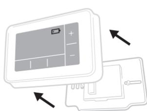
**2.** Vyměňte staré baterie a vložte nové.
