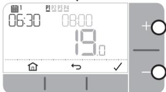
6. Pomocí tlačítek + a – nastavte čas konce úseku a po té stiskněte tlačítko ✓
